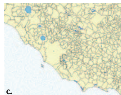
Figura 1 - Esempi di dati in formato vettoriale: a. dati puntuali (per esempio, eventi epidemiologici, sorgenti di inquinamento, centraline di rilevamento atmosferico); b. dati lineari (per esempio, fiumi, strade, curve di livello); c. dati areali (per esempio, confini amministrativi).
